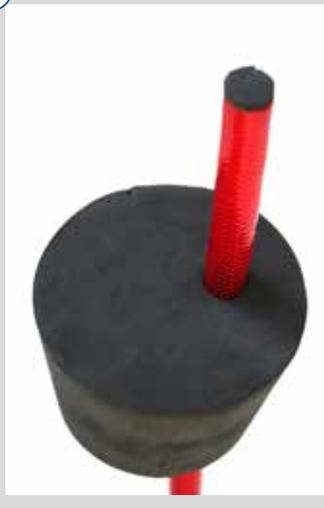
Schlauch durch die dünne oberste Schicht stoßen. Der Stanz-Rest bleibt am Schlauchende kleben.
